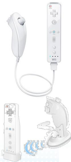
Autre exemple avec le système développé par BIGBEN INTERACTIVE consistant à brancher un récepteur et un transmetteur sur chacune des manettes Wii. Ces récepteurs et transmetteurs sont aujourd'hui directement intégrés à l'intérieur même de la Wiimote et du Nunchuck, avec des options spécifiques.
